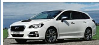
zeuge von Subaru verkauft wurden. Jüngster Spross ist der Subaru Levorg 4x4, ein sportlicher Kombi modernster Prägung. Sein direkt einspritzender 1,6-l-Boxermotor leistet 170 Turbo-PS. In das automatische Lineartronic-Getriebe kann mit Schaltwippen eingegriffen werden. Einzigartig ist das EyeSightssystem, das die Strasse vor dem Auto überwacht.
