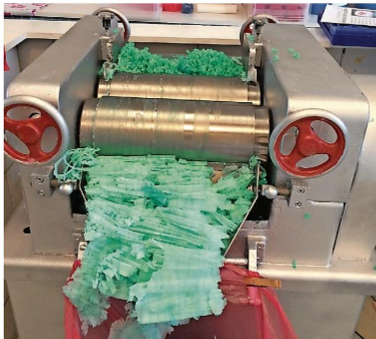
Damit die Seifenmasse homogen wird, werden Seifengranulate in einem Walzwerk piliert.
